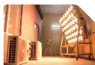
Test provozu při vysokých teplotách
